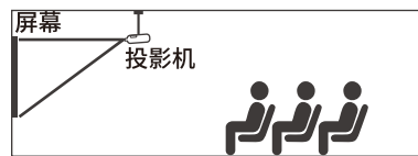
1. 支架吊装正投
