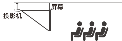
2. 支架吊装背投
